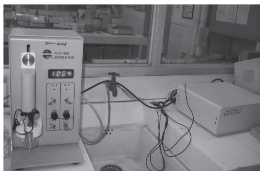
用于电化学和水质金属含量分析的 旋转圆盘电极
