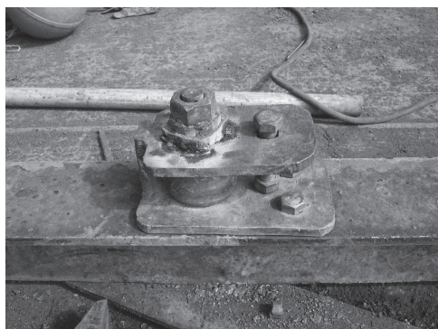
“弓箭式”穿引方法中使用的自制导向轮
