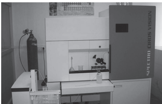
用于样品化学元素分析的等离子光谱仪
