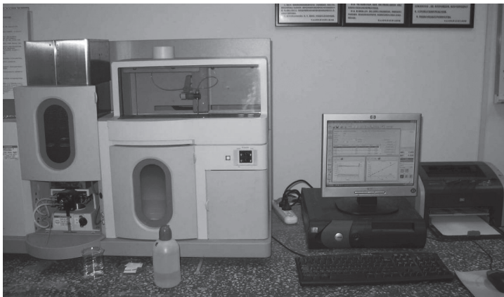
用于水化学成分分析的紫外分光光度计
